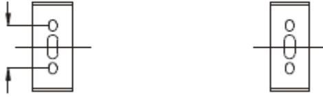
2. **Insérez une cheville de 6 mm dans le trou et fixez le support par une vis M4/ Insert a 6mm expansion pipe into the hole and fix the bracket by M4 screw**
