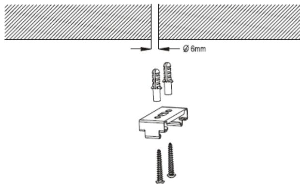
3. **Installez l'applique linéaire à l'aide des supports / Install the linear wall light using the brackets**
