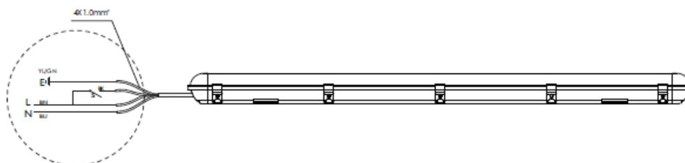
**Le circuit intérieur avec dispositif d'urgence est déjà connecté**
